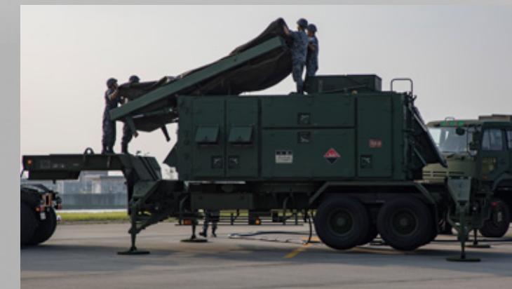
8月29日、岩国基地で行われた地对空誘導弾ペトリオット(PAC-3)展開訓練で、MIM-104ペトリオットミサイルシステムの設置を行う航空自衛隊、第2高射群の自衛隊員。 Service members with the Japan Air Self-Defense Force (JASDF) 2nd Air Defense Missile Group, set up the AN/MPQ-65 radar set during Patriot Advanced Capability-3 (PAC-3) deployment training at Marine Corps Air Station Iwakuni, Japan, Aug. 29, 2017.
