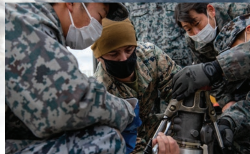
2021年12月14日、百里基地で航空自衛隊第7航空団の隊員に航空燃料中の不純物を調べるためのテストキットの使い方を見せる、第171海兵航空師団支援中隊、バルク燃料専門職のブレンデン・ブリーデン伍長(写真中央)。写真：エバンス・ジョーンズ伍長 U.S. Marine Corps Cpl. Brenden Breeden, a bulk fuel specialist with Marine Wing Support Squadron 171, demonstrates how to use an aviation test kit to check for sediment in fuel to Airmen with 7th Air Wing, Japan Air Self-Defense Force, at Hyakuri Air Base, Japan, Dec. 14, 2021. Photo by Cpl. Evan Jones
