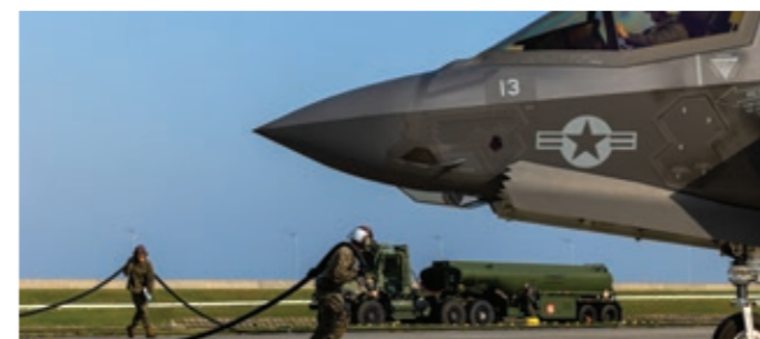
前方武装給油ポイント (FARP) 訓練でF-35BライトニングIIへの給油を準備する第171海兵師団支援中隊 (MWSS-171) と第242海兵戦闘攻撃中隊 (VMFA-242) の米海兵隊員たち。 U.S. Marines with Marine Wing Support Squadron 171 and Marine Fighter Attack Squadron (VMFA) 242 prepare to refuel an F-35B Lightning II aircraft during forward arming refueling point training.
