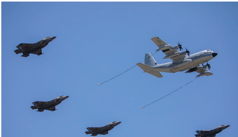
空中給油を実演する、第152海兵空中給油輸送中隊 (VMGR-152) 所属のKC-130Jスーパーハーキュリーズと第121/第242海兵戦闘攻撃中隊 (VMFA-121/VMFA-242) 所属のF-35BライトニングII。写真:マケイラ・レイズ兵長 A U.S. Marine Corps KC-130J Super Hercules aircraft with Marine Aerial Refueler Transport Squadron (VMGR) 152, and four F-35B Lightning II aircraft with Marine Fighter Attack Squadron (VMFA) 121 and VMFA-242, demonstrate aerial refueling. Photo by Lance Cpl. Maikeyla Reyes
